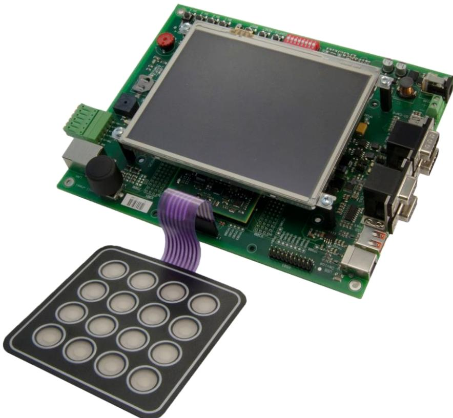
*Bild 8: Anschluss der Folientastatur an das Developmentboard*
